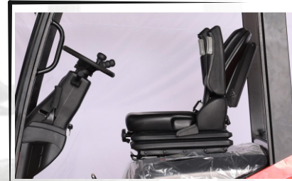
SÜSPANSİYONLU ÇİFT KOL DAYAMALI KİLOGRAM AYARLI KOLTUK
