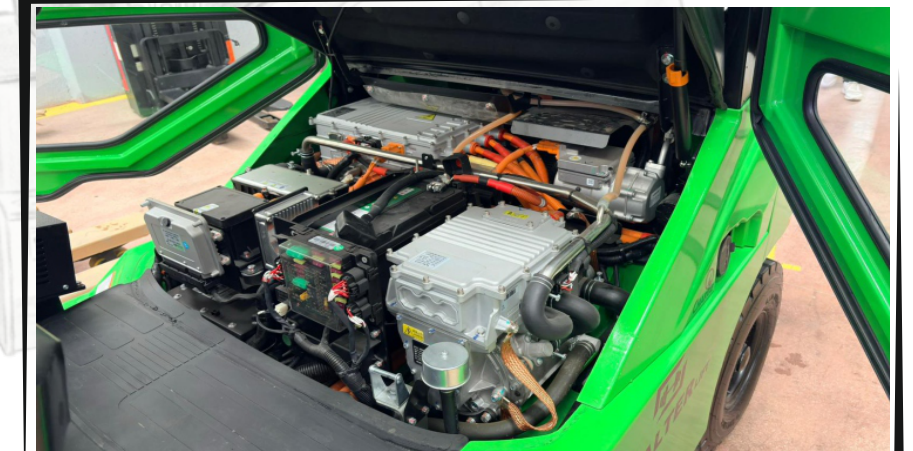
Sıcaklık stabilizasyon teknolojisi, IP68 koruma seviyesi, soğutucu fan sistemi, ısı kompresörü ve longlife kırmızı antifriz desteği sayesinde en zorlu çalışma koşullarında dahi maksimum koruma ve optimum çalışma sıcaklığı sağlanmaktadır.
