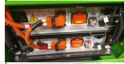
Sınıfının en iyisi CATL marka hücre yapısı ve 309.12 Volt LiFePO4 lityum akü sistemi
