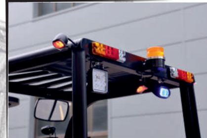
Ön ve Arka Blue Spot Sağ - Sol ve Arka Kırmızı Güvenlik Işıkları
