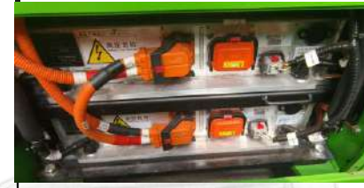
Sınıfın en iyisi CATL marka hücre yapısı ve 309.12 Volt LiFePO4 lityum akü sistemi
