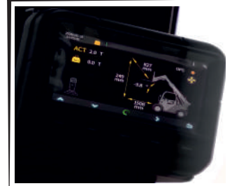
ANLIK ÇALIŞMA PARAMETLERİ SUNAN AKILLI OPERATÖR EKRANI
